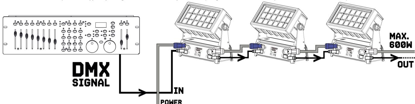
**UWAGA!** Na ostatnim urządzeniu musisz mieć linię DMX z rezystorem końcowym. Weź złącze XLR i przymontuj rezystorem 120 Ohm między sygnałem (-) a sygnałem (+) i podłącz go do wyjścia DMX ostatniego urządzenia w linii.
