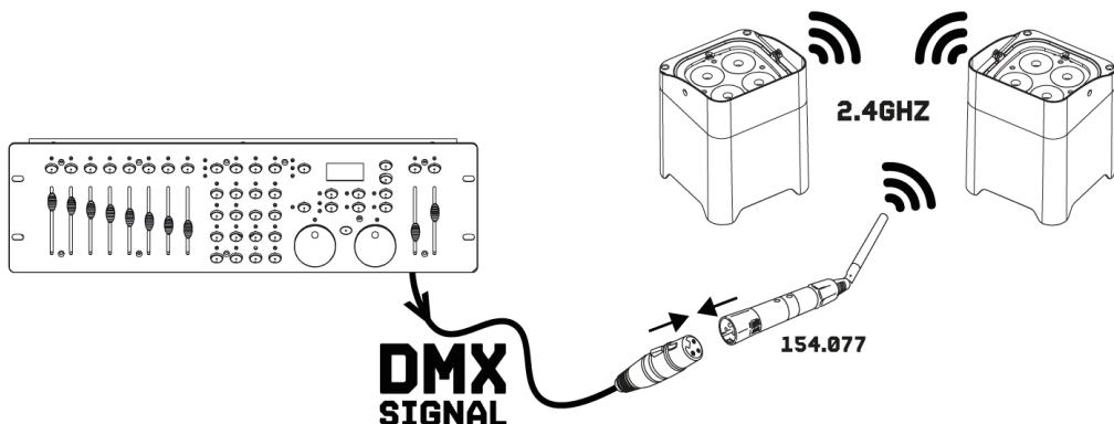
Uruchomić nadajnik i odbiornik BBP W-DMX podłączając jego zasilacz do wejścia zasilania, a wtyczkę sieciową do gniazda sieciowego (100-240V~, 50/60 Hz). Wskaźnik stanu krótko migna na czerwono.
