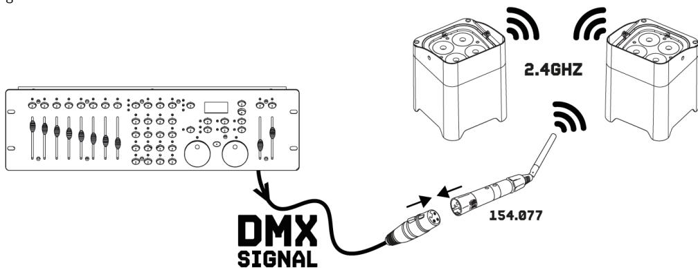
Setzen Sie die BBP W-DMX Sender und Empfänger in Betrieb, indem Sie das Netzteil an den Netzeingang und den Netzstecker an eine Netzsteckdose (100-240V~, 50/60 Hz) anschließen. Die Statusanzeige blinkt kurz rot.
