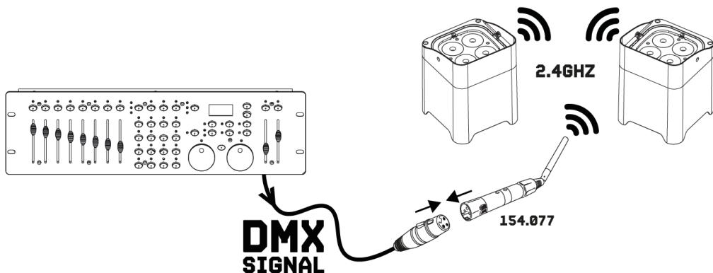
Ponga en funcionamiento el transmisor y el receptor BBP W-DMX conectando su unidad de alimentación a la entrada de corriente y el enchufe de la red eléctrica a una toma de corriente (100-240V~, 50/60 Hz). El indicador de estado parpadea brevemente en rojo.
