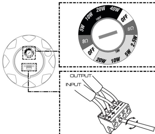
**NOTA:** El cableado de un sistema de 70/100V sólo puede ser realizado por un electricista cualificado. La carga total no debe superar la potencia nominal del amplificador. Si el sistema de 70/100V está encendido, apáguelo antes de conectarlo. Asegúrese de que el interruptor giratorio del altavoz esté en "off" antes de conectarlo.
