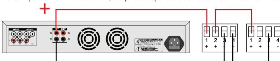
\* Les deux canaux de sortie de l'amplificateur gauche et droit peuvent être utilisés dans le cas ci-dessus.
