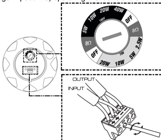
**OPMERKING:** De bekabeling van een 70/100V systeem mag alleen door een erkende elektricien worden uitgevoerd! De totale belasting mag het nominale vermogen van de versterker niet overschrijden. Als het 70/100V systeem aan staat, zet het dan uit voordat u het aansluit. Zorg ervoor dat de draaischakelaar op de luidspreker op "off" staat voordat u deze aansluit.
