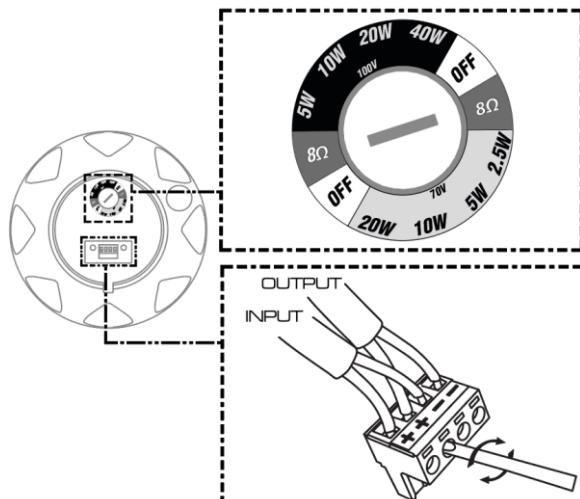
**REMARQUE:** Le câblage d'un système 70/100V ne peut être effectué que par un électricien qualifié ! La charge totale ne doit pas dépasser la puissance nominale de l'amplificateur. Si le système 70/100V est allumé, éteignez-le avant de le connecter. Assurez-vous que le commutateur rotatif de l'enceinte est sur "off" avant de procéder au raccordement.
