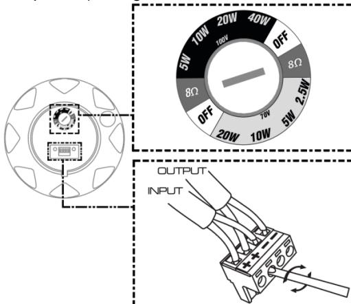
**HINWEIS:** Die Verdrahtung eines 70/100V-Systems darf nur von einer Elektrofachkraft durchgeführt werden! Die Gesamtlast darf die Nennleistung des Verstärkers nicht überschreiten. Wenn das 70/100-V-System eingeschaltet ist, schalten Sie es aus, bevor Sie es anschließen. Vergewissern Sie sich, dass der Drehschalter des Lautsprechers auf "off" steht, bevor Sie ihn anschließen.
