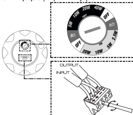
**UWAGA:** Okablowanie systemu 70/100 V może być wykonane wyłącznie przez wykwalifikowanego elektryka! Całkowite obciążenie nie może przekraczać mocy znamionowej wzmacniacza. Jeżeli system 70/100 V jest włączony, przed podłączeniem należy go wyłączyć. Przed podłączeniem głośnika należy upewnić się, że przełącznik obrotowy na głośniku jest ustawiony w pozycji "off".
